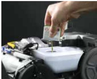
Sie müssen nur eine einzige Chemical Card in den FIMOP Tank leeren, um eine perfekt ausgewogene Reinigungslösung zu haben
